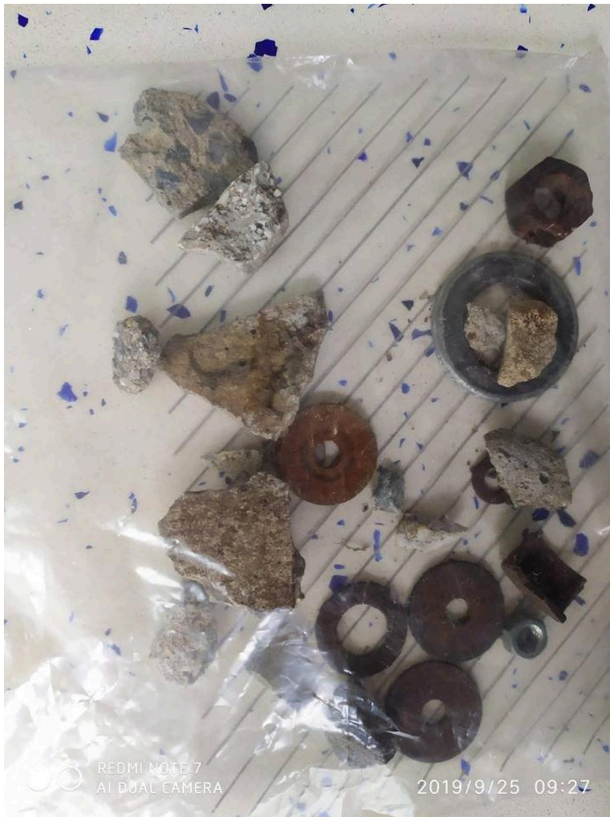
**Genova.** Frammenti di cemento, parti metalliche, bulloni e rondelle, il tutto “precipitato” dal ponte su giardini e terrazzi in queste settimane: questo è il ‘raccolto’ che gli abitanti delle Gavette che abitano nei pressi del viadotto Bisagno intendono mettere a disposizione delle autorità.
