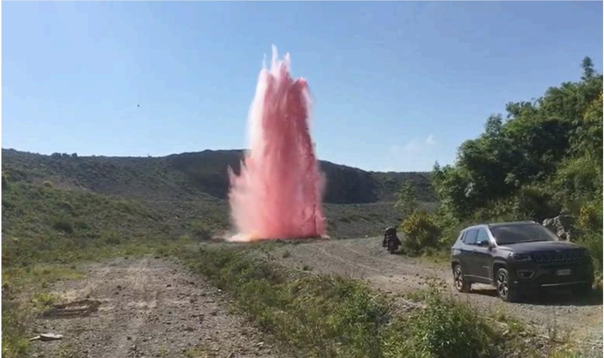
**Genova.** Sono terminate le prove nella ex cava dei Camaldoli per testare le misure mitigative da porre in atto in previsione della demolizione delle pile 10 e 11, e anche gli effetti delle cariche esplosive sugli stralli.
