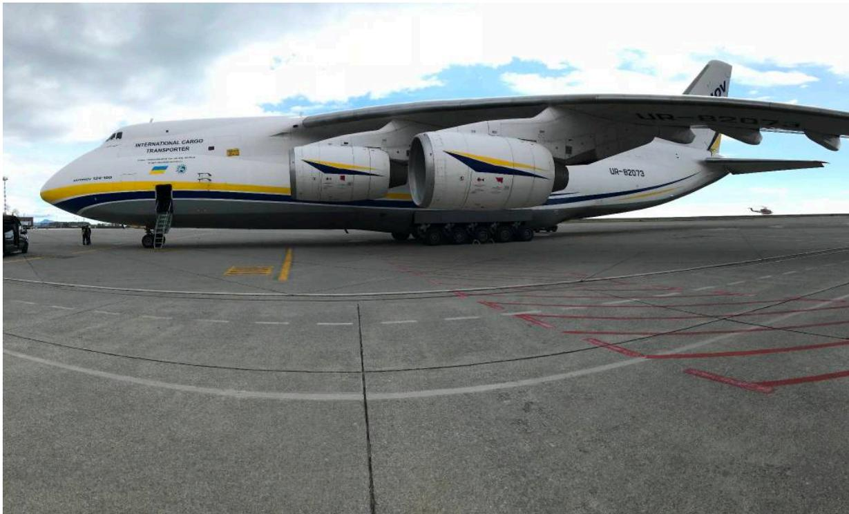
Con una lunghezza di 69 metri, un'apertura alare di 73, un carico utile di 120 tonnellate e una massa al decollo a pieno carico di 392mila chili, l'Antonov An-124 è il più grande aereo cargo mai costruito in serie. A renderlo speciale ci sono anche il muso apribile, per consentire la movimentazione del carico, e il carrello di atterraggio retraibile, che facilita lo spostamento delle merci trasportate.
